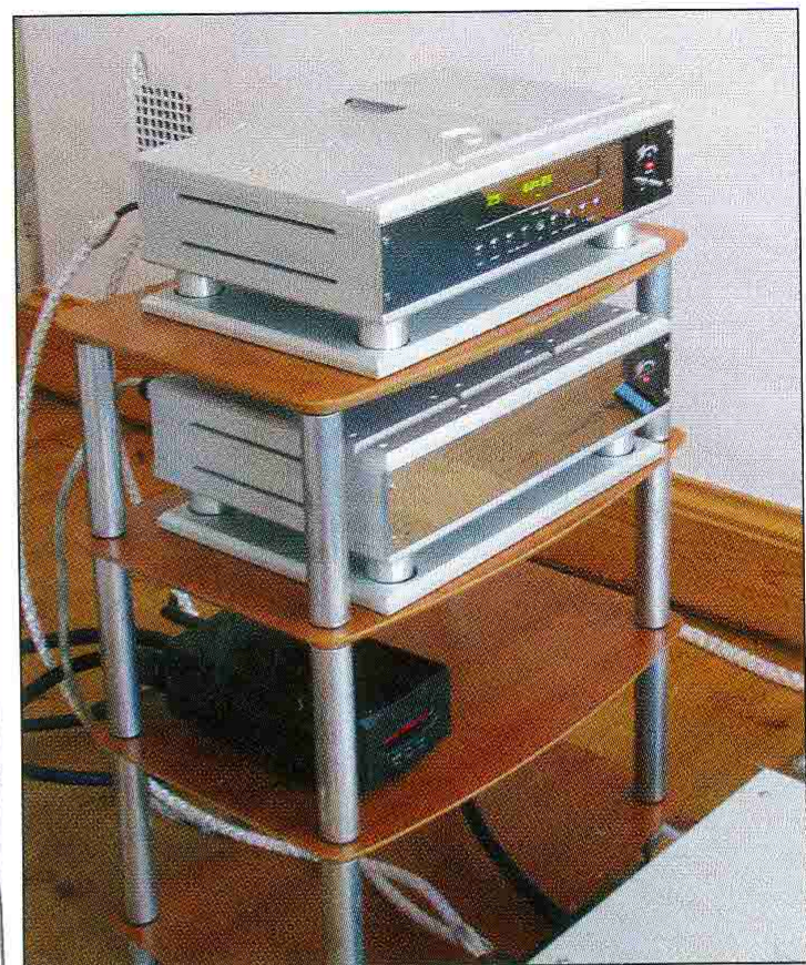
Burmester 069: hihnaveto, lataus päältä ja erillinen virtalähde
